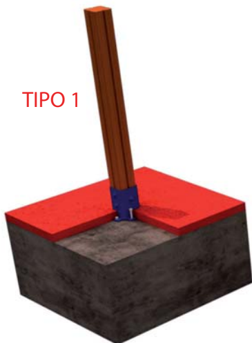
FIJACION A SOLERA DE HORMIGON
