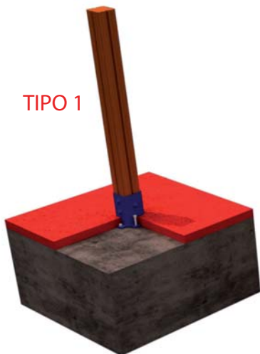
FIJACION A SOLERA DE HORMIGON
